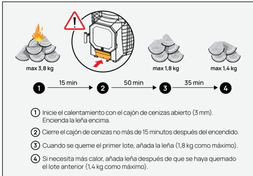
Figura 17. Inicio del calentamiento de HIVE Flow Mini y adición del lote de leña.
