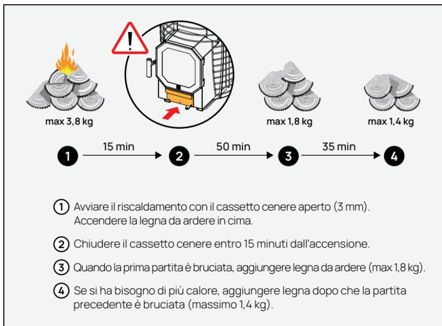
Figura 17. Avvio del riscaldamento HIVE Flow Mini e aggiunta della legna da ardere.
