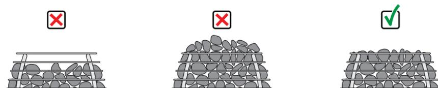
Figura 14. Colocación de las piedras de HIVE Flow.
