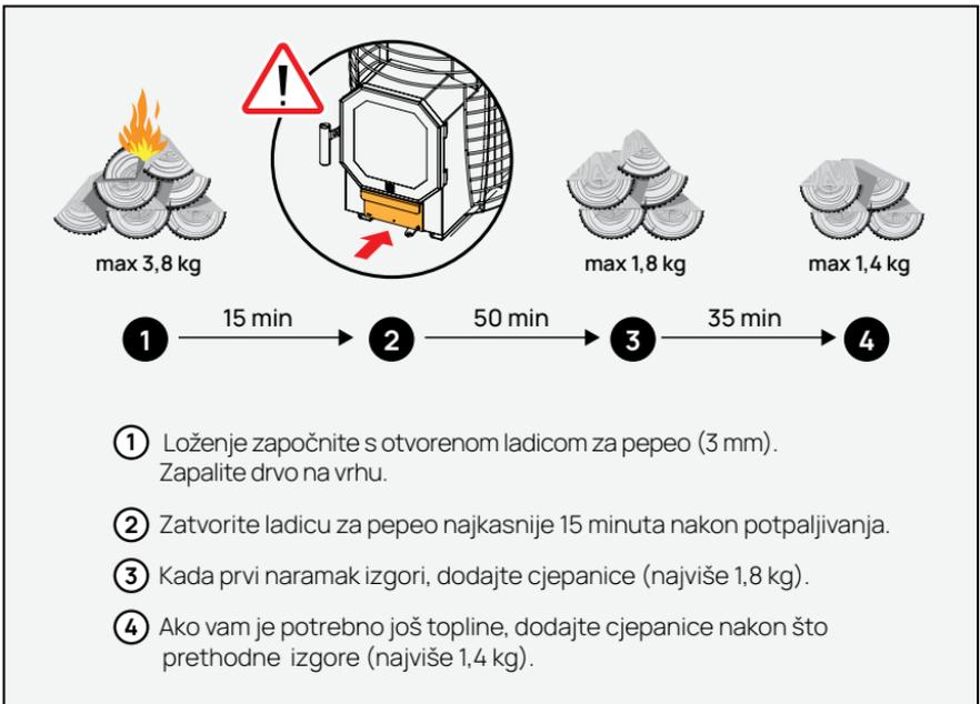
Slika 17. Loženje peći HIVE Flow Mini i dodavanje cjepanica.
